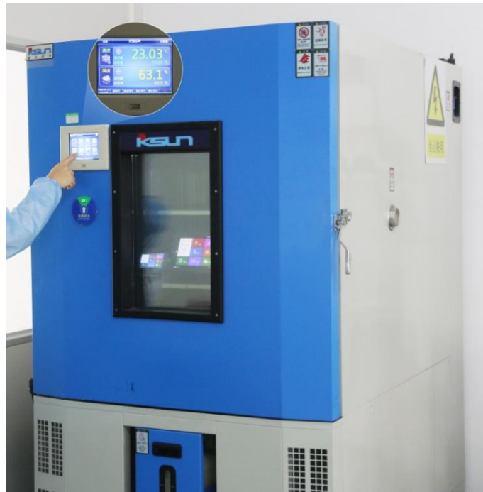
图 4-3 高低温老化测试图
